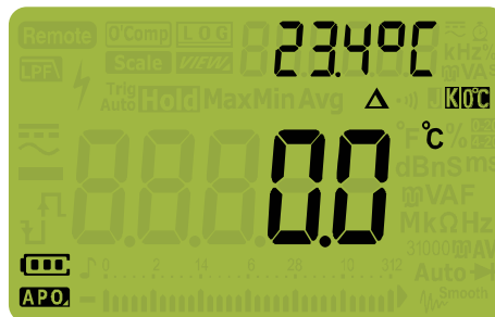
Figura 2-28 Misurazione della temperatura senza compensazione ambiente
