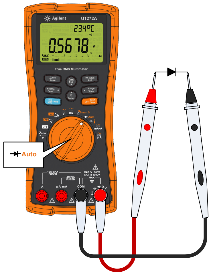
Figura 2-20 Test di diodi con polarizzazione diretta
