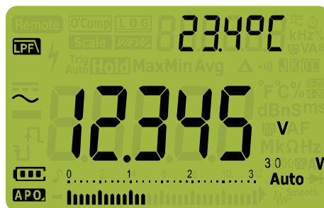
Figura 2-3 Tensione CA con visualizzazione LPF
