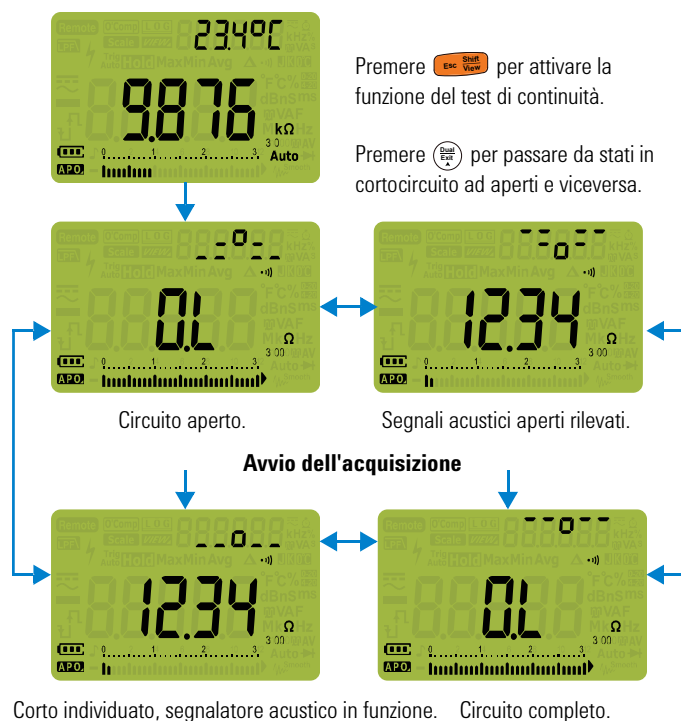
Figura 2-14 Operazione di continuità
