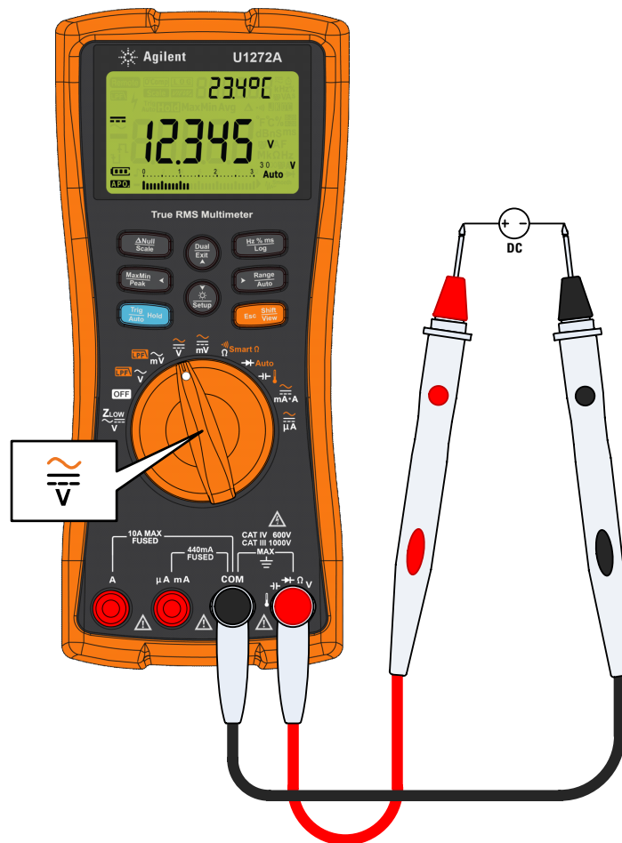
Figura 2-6 Misurazione della tensione cc
