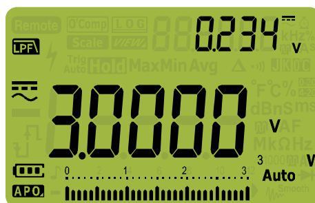
Figura 2-4 Accoppiamento CC per misurazioni della tensione ca+cc
