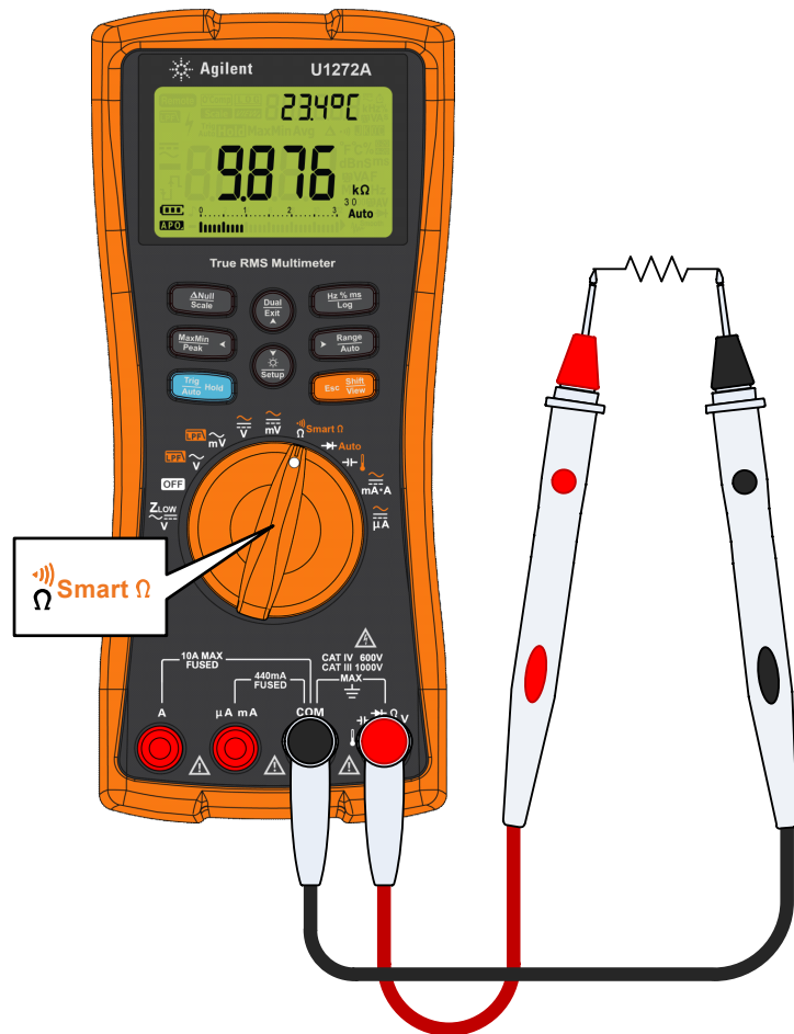
Figura 2-13 Misurazione della resistenza
