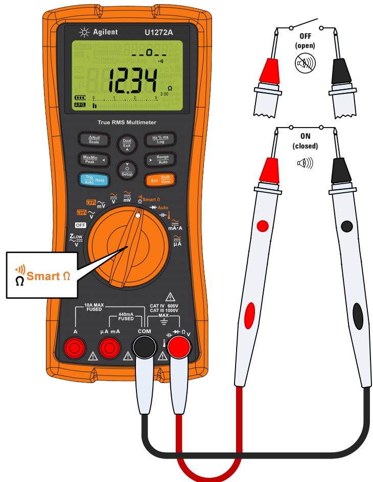
Figura 2-15 Test di continuità
